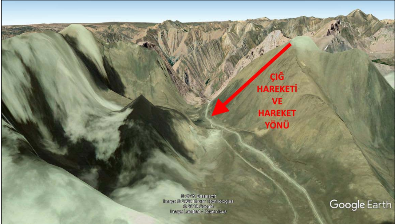
Şekil 2: Çığ afetinin gerçekleştiği Karabet Geçidi'nin doğudan batıya görünümü. Olayın gerçekleştiği yamaçın yüksek eğimi, bitki örtüsünden yoksunluğu ve karayolunun yamaç eteğindeki konumu net olarak görülmektedir. Tüm bu koşullar çığ oluşumunu desteklemektedir.
